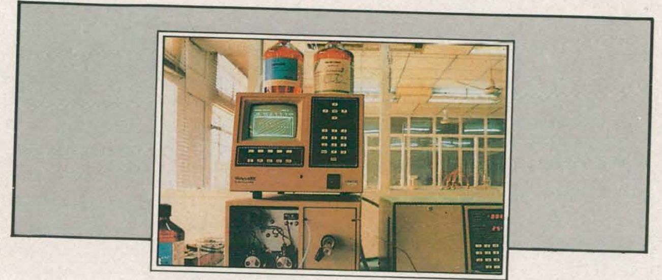
कीट नाशकों का उच्च कार्यकारिता द्रव क्रोमेटोग्राफी (एच पी एल सी) द्वारा परीक्षण
