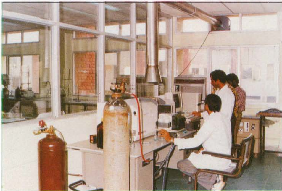
परमाणविक अवशोषण स्पेक्ट्रोफोटोमीटर द्वारा परीक्षण Testing by atomic absorption spectrophotometer
